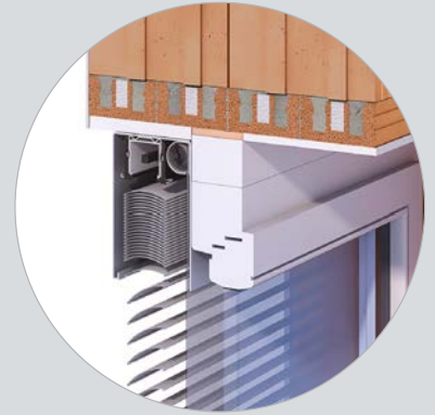
Aufputzkasten mit Raffstore und integriertem Insektengitter-Rollo
